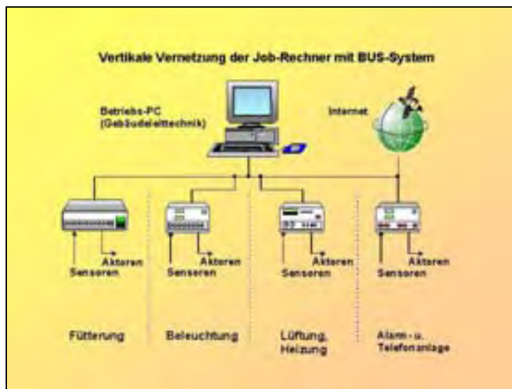
Bild 16: Eine Vernetzung von Prozesscomputern macht ein herstellerübergreifendes BUS-System als Kommunikationsplattform notwendig
