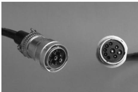
**Abb. 7:** LBS Steckverbindung Traktor/Gerät
