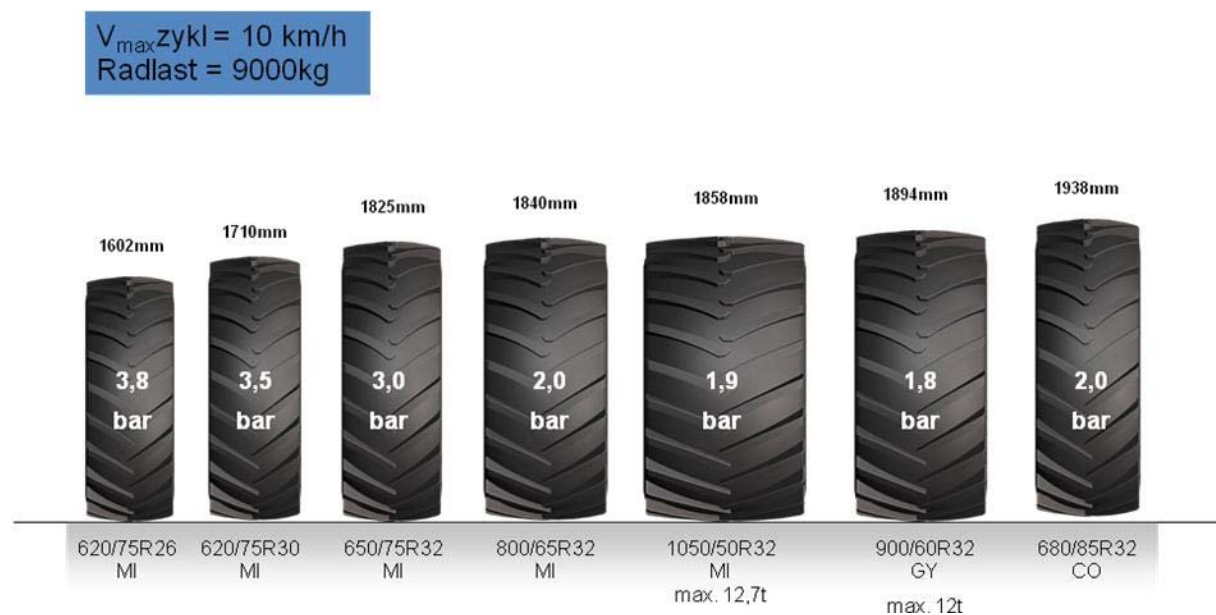
Abb. 11: Reduzierung des Reifendruckes durch Vergrößerung der Auflagefläche und Vergrößerung des Außendurchmessers bei Erntemaschinenreifen
