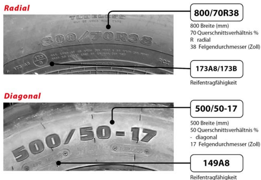
Abb. 2: Beschriftung an Radial- und Diagonalreifen
