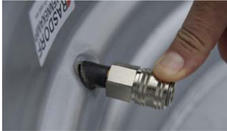
Abb. 46: Das Gummifußventil ist nicht für den Einsatz eines Schnellentlüfteraufsatzes geeignet.
