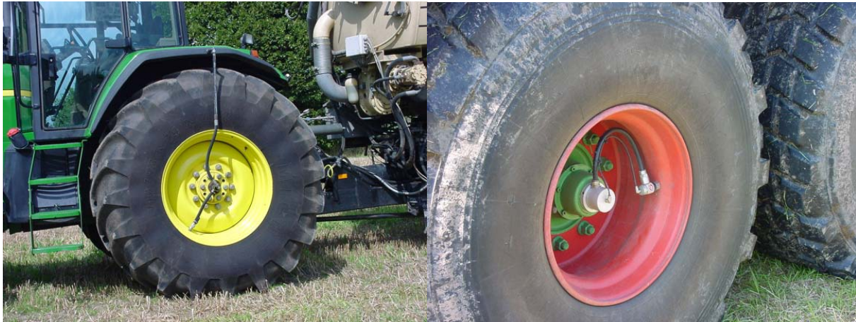
Abb. 49: Einleitungs-Reifendruckregelanlage mit außenliegender Luftzufuhr (links) und Zweileitungs-Reifendruckregelanlage mit innenliegender Luftzufuhr (rechts)
