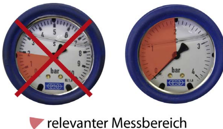
Abb. 39: Manometer mit unterschiedlichen Messbereichen
