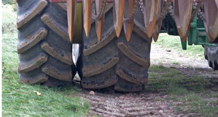
Abb. 31: Berührung der Reifen aufgrund eines zu kleinen Distanzringabstandes
