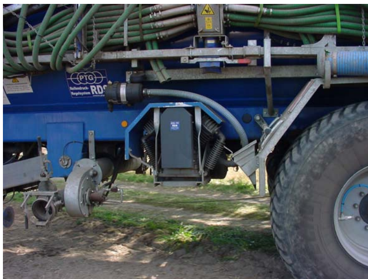
Abb. 51: 2-Kolben-Kompressor am Güllefaß
