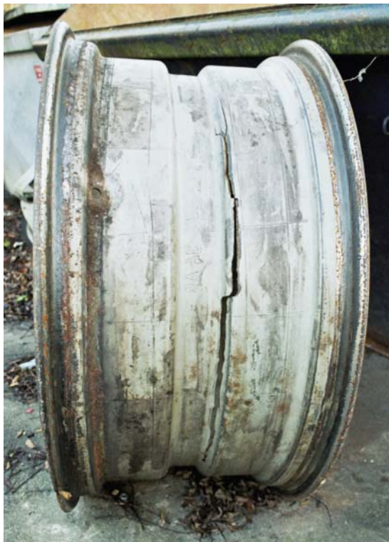
Abb. 23: gerissener Felgenring; die Folge eines Haarisses in der Verbindung Felgenring/Radschüssel
