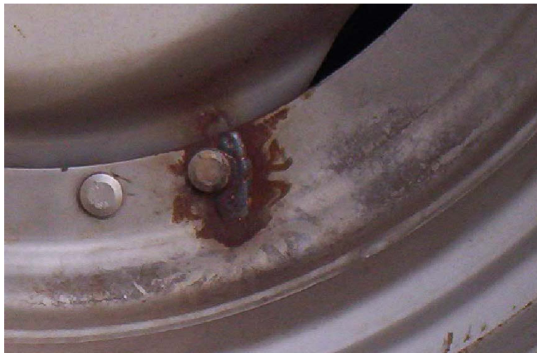
Abb. 16: Überlastungsschaden an einer Spurverstellfelge
