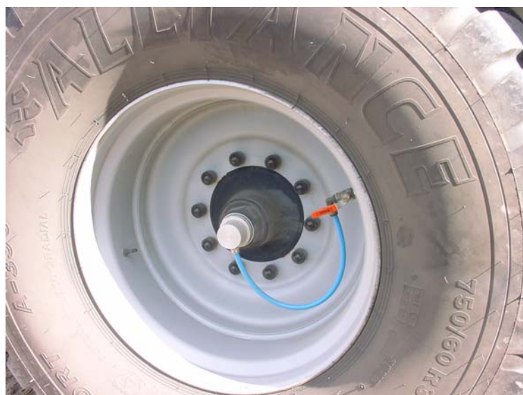
Abb. 50: Absperrhahn am Ventil bei einer Einleitungs-Reifendruckregelanlage
