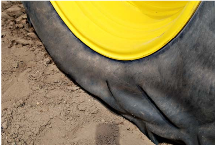
Abb. 44: Faltenschlag bei zu niedrigem Reifeninnendruck
