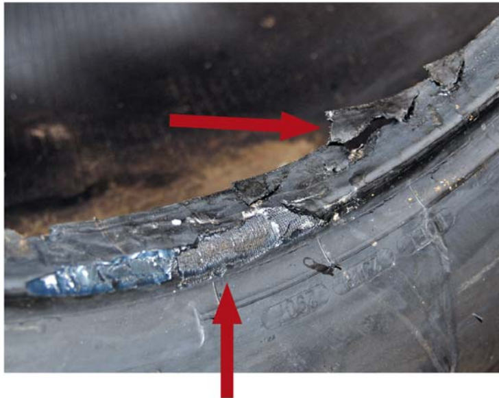
Abb. 13: Wulstschaden, Folge einer unsachgemäßen Montage
