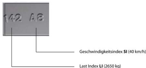
Abb. 4: Lastindex und Geschwindigkeitsindex
