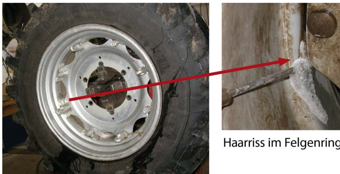
Abb. 22: Haarrisse im Felgenring lassen sich mit Lecksuchspray lokalisieren
