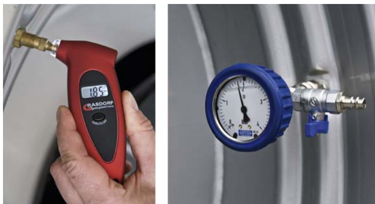
Abb. 40: Luftdruckprüfer mit digitaler und analoger Anzeige
