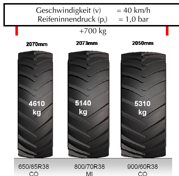
Abb. 10: Erhöhung der Tragfähigkeit bei Verbreiterung der Aufstandsfläche
