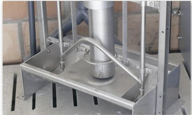
Abbildung 3: Rohrbreiautomat mit beweglichem Rohr
