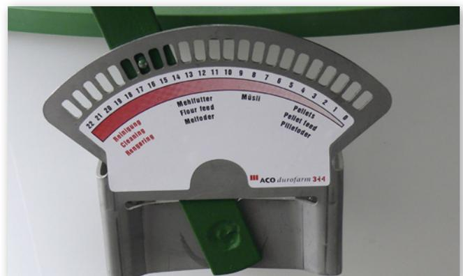
Abbildung 4: Dosierskala eines Rohrbreiautomaten
