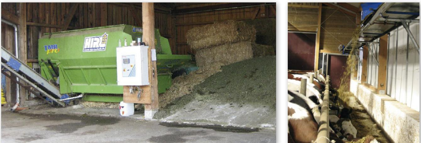
Abbildung 3: Links: Stationärer Mischer mit Steuereinheit; Rechts: über dem Futtertisch angebrachtes Förderband
