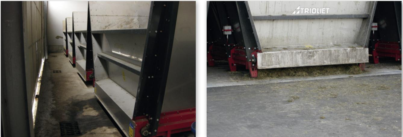
Abbildung 9: Links: Ableitungsmöglichkeiten für Reinigungswasser und Gärsaft; Rechts: Futterreste an Reinigungs-klappe (Quelle: Oberschätzl)
