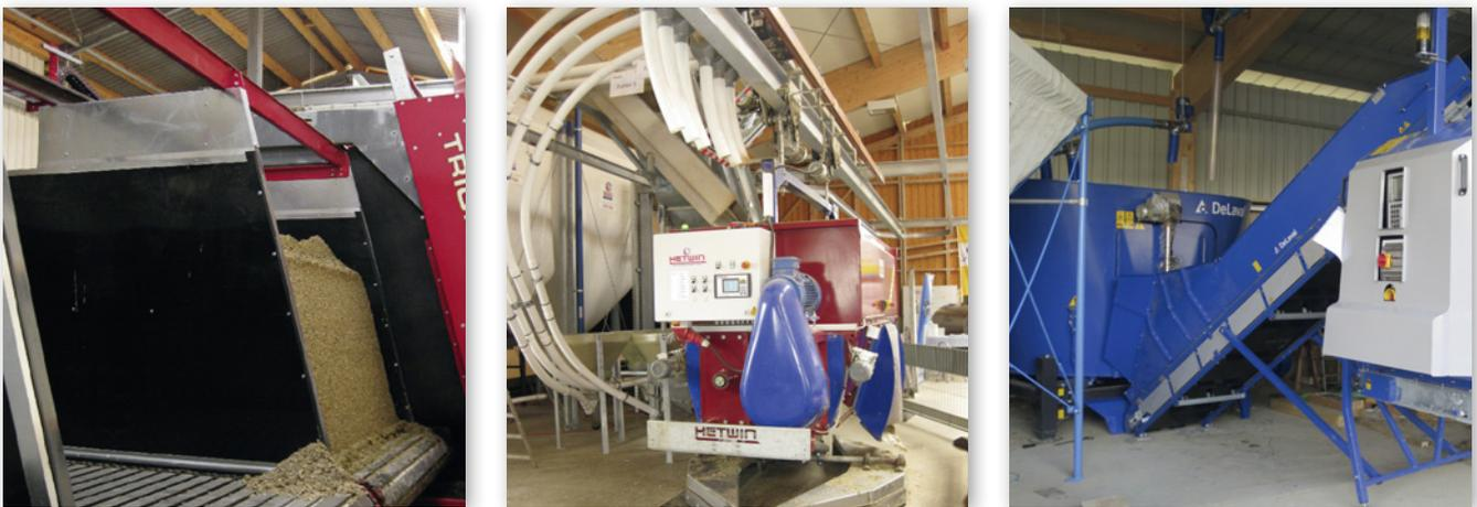
Abbildung 4: Links: Vorratsbehälter; Mitte: Schienengeführter Misch- und Verteilwagen; Rechts: stationärer Mischer und schienengeführter Verteilwagen (Quelle: Oberschätzl)
