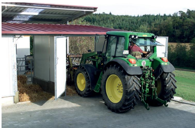
**Abbildung 13:** Frontlader-Entmistung der Gruppenhütte (Quelle: Förster-Technik)
