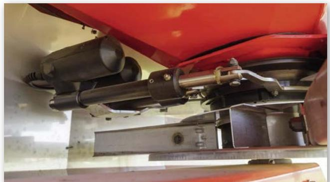
Abbildung 15: Elektrische Schieberbetätigung
