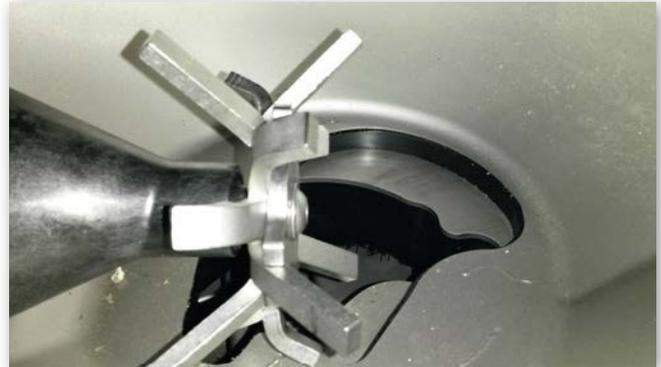
Abbildung 14: Teilgeschlossene Dosiervorrichtung
