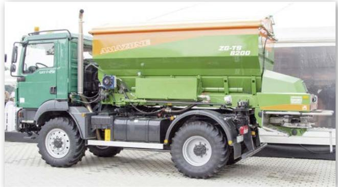
Abbildung 10: Düngerstreuer auf einem Trägerfahrzeug (Quelle: Scheufler)
