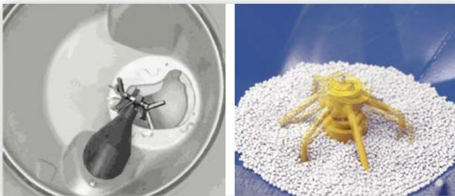
Abbildung 16: Spiralrührwerk von Amazone (links) und Rührkrone von Bogballe (rechts) (Quelle: Scheufler)
