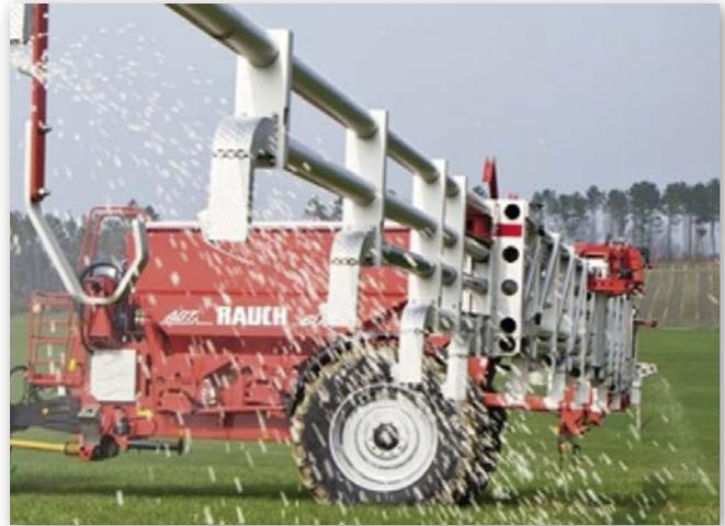
Abbildung 32: Gestänge mit Verteildüsen
