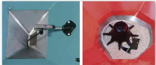
Abbildung 17: Oszillierendes Zinkenrührwerk von Sulky-Burel (links) und pulsierend-drehendes Rührwerk von Rauch (rechts) (Quelle: Scheufler)
