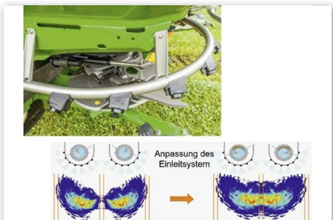
Abbildung 31: Automatische Regelung der Lage des Streufächers (Quelle: Scheufler)
