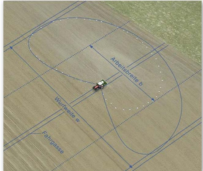
Abbildung 4: Ausdehnung des Streufächers auf der Feldfläche – Arbeitsbreite  $b = 24 \text{ m}$  (Quelle: Scheufler)
