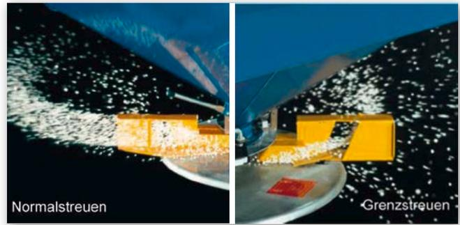
Abbildung 22: Grenzstreuen durch Umkehr der Drehrichtung (Quelle: Scheufler)
