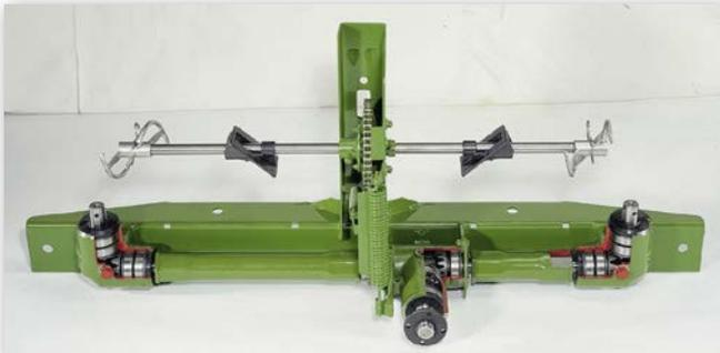
Abbildung 18: Mechanischer Antrieb des Streuwerks
