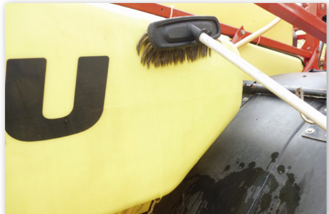
Abbildung 5: So reinigen Sie die Pflanzenschutzspritze auf dem Waschplatz Ihres Betriebs (a), auf dem Feld (b, c) (© Garrelts)
