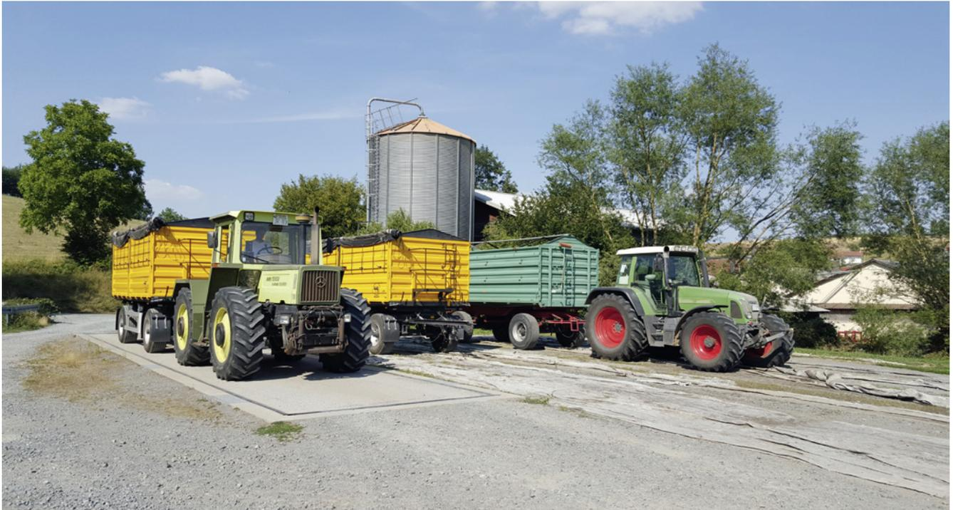
Abbildung 3: Eine geeichte Fuhrwerkswaage ist Voraussetzung für eine mengenmäßige Futtermittelerfassung (Quelle: DLG)
