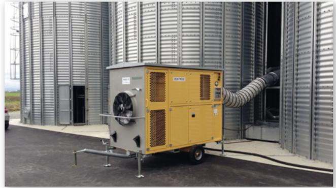
Abbildung 17: Getreidekühlgerät, angeschlossen an eine Siloanlage (Quelle FrigorTec)
