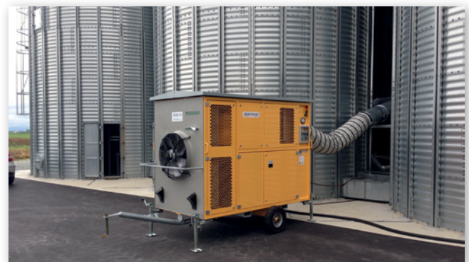
Bild 17: Spannmålskylare, monterad på ett silosystem (källa FrigorTec)
