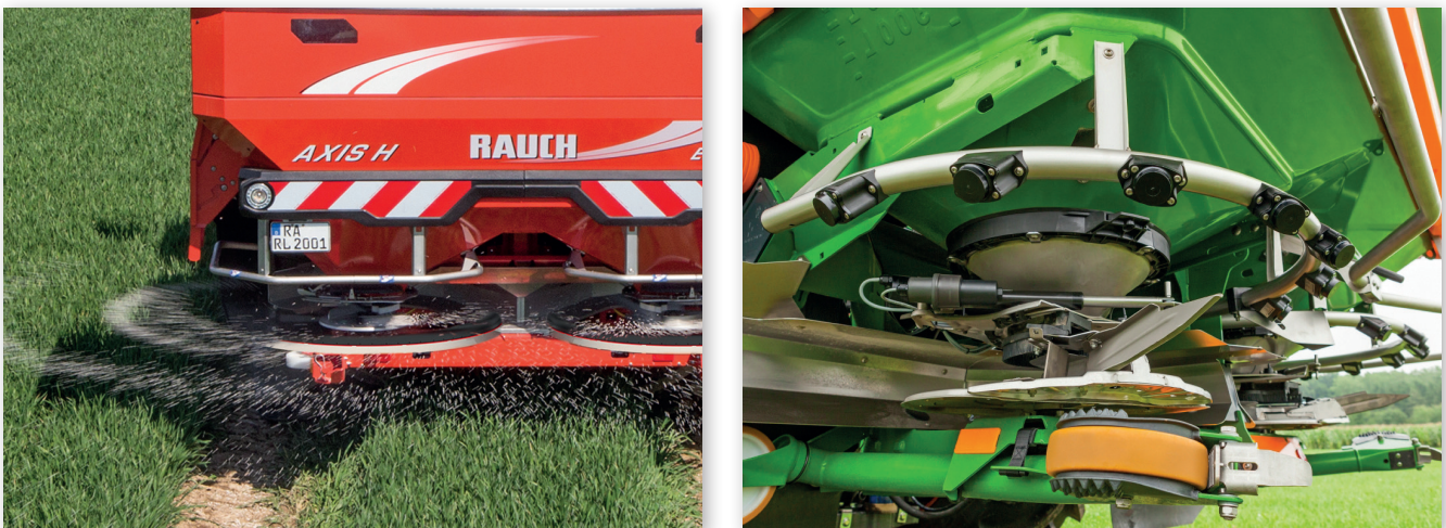
Abbildung 17: Radarsensoren zur Erfassung der Düngerverteilung (Quelle: Werkbild Rauch (links), Werkbild Amazone (rechts))
