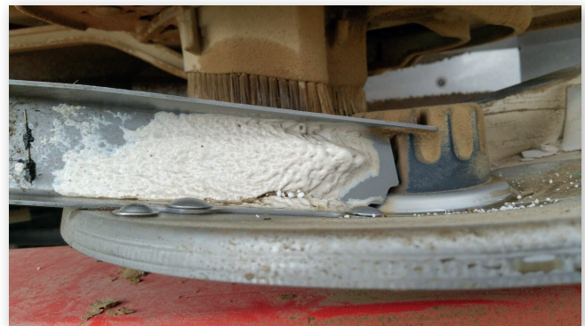
Abbildung 21: Mit Düngeranhaftungen auf den Streuschaufeln wird die Querverteilung massiv beeinflusst (Quelle: von Breitenbuch)
