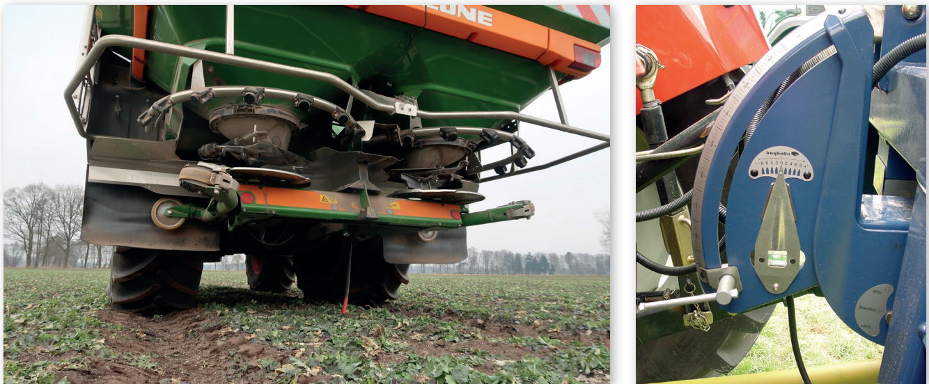
Abbildung 15: Abstandshalter für die richtige Einstellung der Streuscheibenhöhe (links) und Wasserwaage mit Neigungsanzeige für die richtige Einstellung der Streuerneigung (rechts) (Quelle: Lossie (links), Uppenkamp (rechts))
