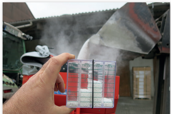
Abbildung 2: Schüttelbox zur Überprüfung der Korngrößenverteilung des Düngers (Quelle: Lossie)
