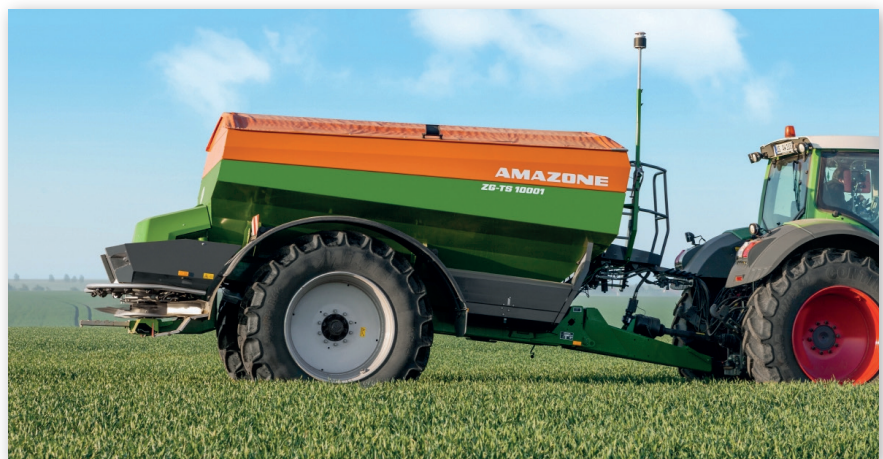
Abbildung 12: Gezogener Düngestreuer, ausgerüstet mit Windmesser (vorne) und Streubildkontrolle (hinten) zum Ausgleich von Seitenwind (Quelle: Werkbild Amazone)
