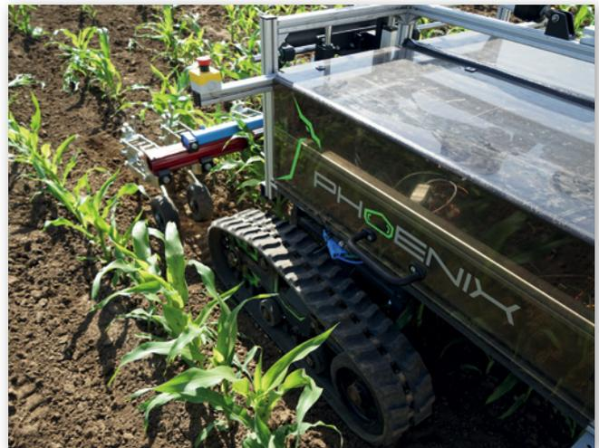
Abbildung 6: Feldroboter unterscheiden sich von konventionellen Landmaschinen und sind häufig auf bestimmte Feldarbeiten spezialisiert (Foto: Griepentrog)
