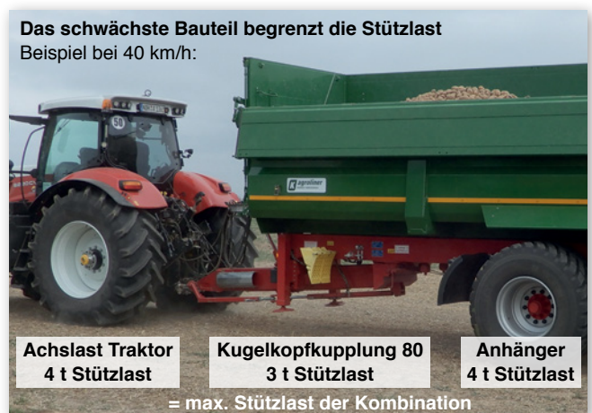
Abbildung 2: Die maximale Stützlast der Fahrzeugkombination ist von mehreren Faktoren abhängig. Hinweise geben die Zulassungsbescheinigungen, die Typenschilder und die Bedienungsanleitungen der Hersteller (Quelle: Vaupel)
