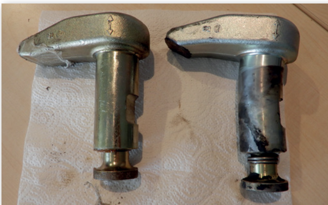
Abbildung 12: Werkzeuglos zu verstellender Niederhalter, der sich bedingt durch negative Stützlasten in Kombination mit der Überschreitung der zulässigen Bewegungswinkel verbogen hat (linkes Bild). Der Niederhalter ist auf Abnutzung und Risse zu kontrollieren (Quelle: Vaupel)
