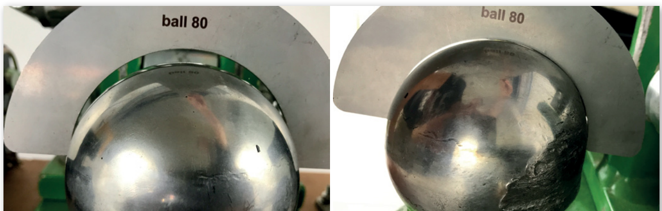
Abbildung 9: Bei der neuen Kugel liegt die Messlehre nicht auf (links). Die verschlissene Kugel zeigt deutliche Riefen und die Abnutzung wird durch die aufliegende Lehre sichtbar (rechts) (Quelle: Walterscheid GmbH)
