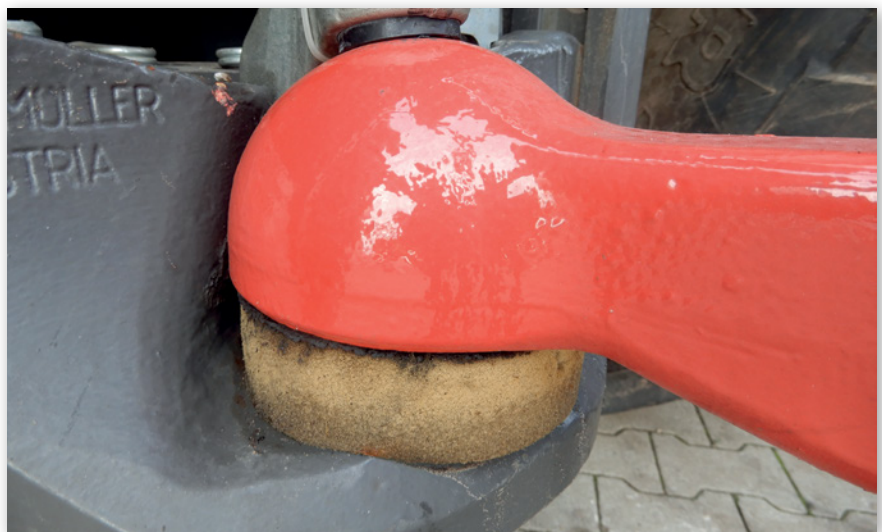
Abbildung 14: Der Staubring soll das Eindringen von Schmutz und Staub verhindern. Bei Beschädigungen ist der Staubring auszutauschen (Quelle: Vaupel)
