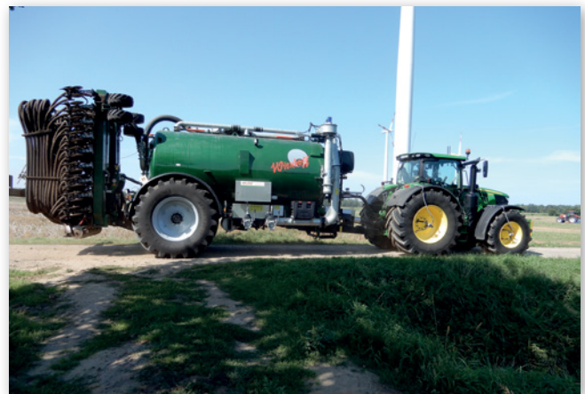
Abbildung 16: Vorsicht! Durch das schwere Schlitzgerät am Heck des Güllewagens können, insbesondere bei leerem Fass, negative Stützlasten auftreten (Quelle: Vaupel)
