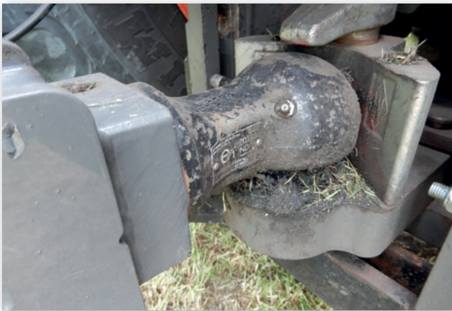
Abbildung 11: Zu viel Spiel: Der Abstand zwischen Niederhalter und Kalotte darf max. 0,5 mm betragen und ist auf diesem Bild viel zu groß. Dadurch können gefährliche Fahrsituationen entstehen (Quelle: Vaupel)
