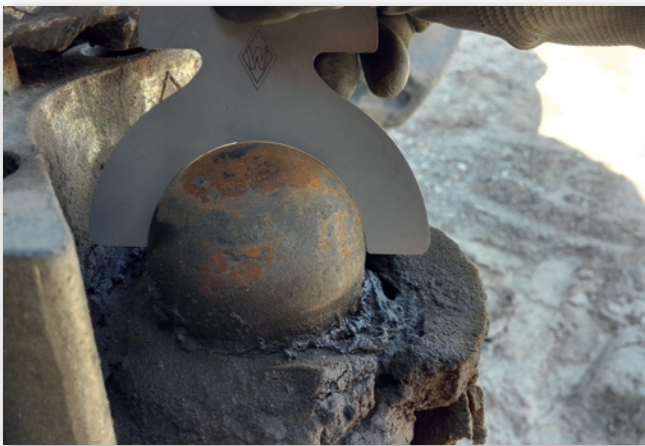
Abbildung 10: Die Messung mit der Prüflehre erfolgt in Fahrtrichtung. Die Verschleißgrenze der Kugel ist fast erreicht. Der Wartungszustand der Kugel ist nicht befriedigend, der Staubring defekt (Quelle: Vaupel)
