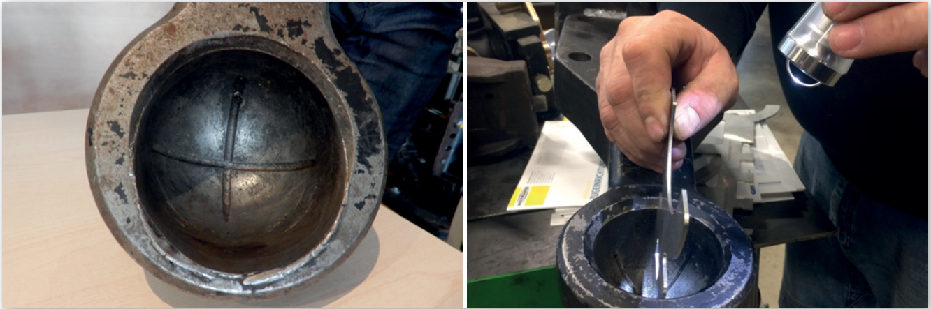
Abbildung 13: Verschlissene Kalotte und Prüfung mit der Taschenlampe (Quelle: Vaupel, Gehring)
