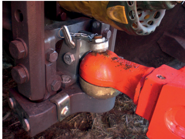
Abbildung 3: Die Stützlast bei Starrdeichselanhängern in der Untenanhängung ist Abhängig von der zulässigen Höchstgeschwindigkeit des Anhängers (Quelle: Vaupel)
