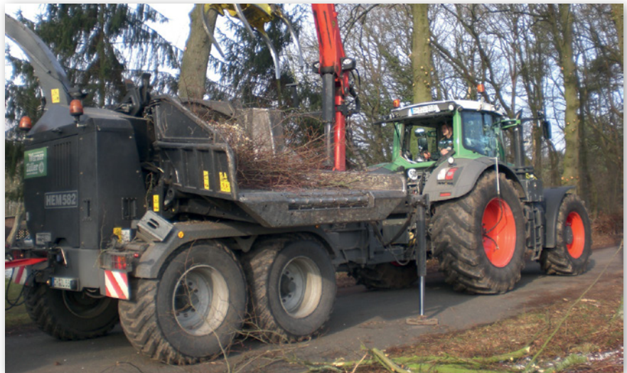
Abbildung 17: Achtung! Werden die Kranstützen beim Holzhacker runtergedrückt, kann es zu starken Beschädigungen am Niederhalter der Kugelkopfkupplung 80 kommen (Quelle: Vaupel)
