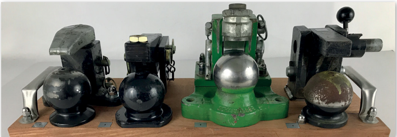
Abbildung 6: Kugelkopfkupplung 80 verschiedener Hersteller mit unterschiedlichen Niederhaltern (Quelle: Walterscheid GmbH)
