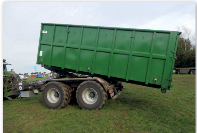
Abbildung 15: Vorsicht! Beim Aufziehen von Container kann es beim Hakenliftanhängern zu negativen Stützlasten kommen. Eine Abstützung mit z. B. hydraulischen Stützfüßen ist empfehlenswert (Quelle: Vaupel)
