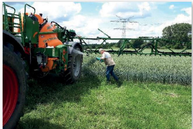
Abbildung 8: Akkubetriebener Hochdruckreiniger mit 200l Wassertank in der Fronthydraulik (links) und im Einsatz (rechts) (Quelle: Kramer)
