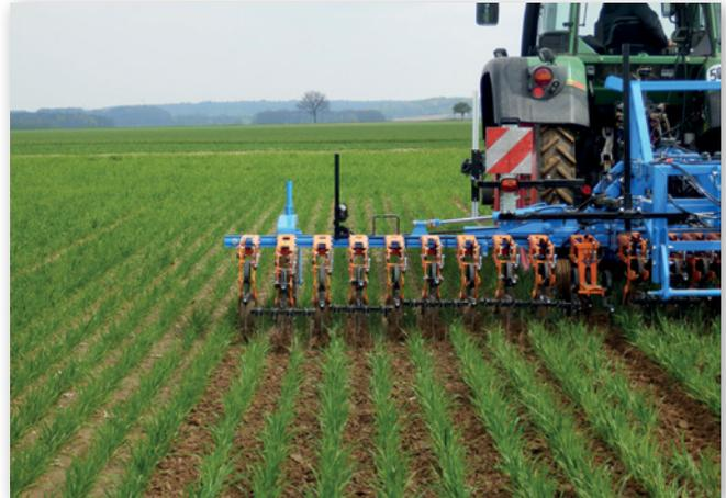
*Abbildung 5: Getreide kann auch als Hackfrucht geführt werden. Mit kamerageführten Scharhacken sind bei 25 cm Reihenabstand hohe Flächenleistungen möglich (Quelle: Markus Mücke, LWK Niedersachsen)*
