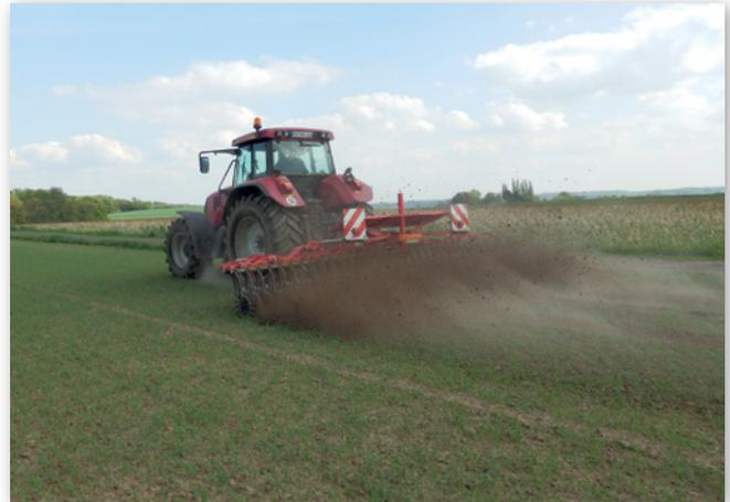
*Abbildung 4: Sternrollhacke passt als Krustenbrecher gut auf lehmige Böden und ist eine sinnvolle Ergänzung zum Zinkenstriegel (Quelle: Markus Mücke, LWK Niedersachsen)*
