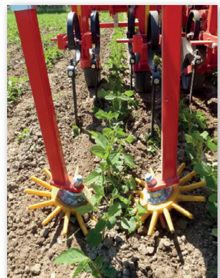
Abbildung 5: Die Fingerhacke ist in Sojabohnen zur Beikrautregulierung innerhalb der Pflanzenreihen geeignet (Quelle: Christian Kreikenbohm, LWK Niedersachsen)
