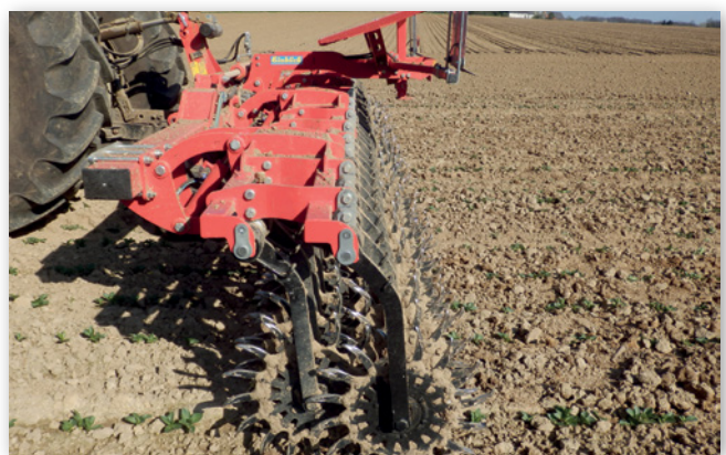
Abbildung 3: Die Sternrollhacke lockert verschlammte und verkrustete Böden und hat auch eine beikrautregulierende Wirkung (Quelle: Markus Mücke, LWK Niedersachsen)
