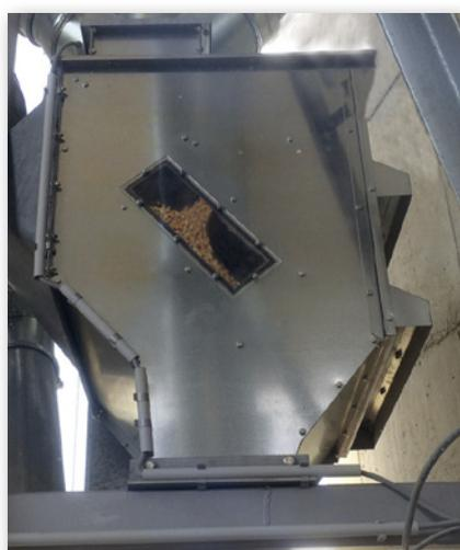
Рисунок 8. Сепаратор Тур NDV (источник: Neuegro)
