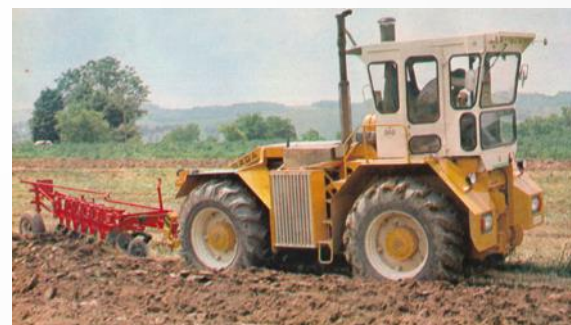
Systemtraktor RÁBA mit Aufsattelpflug nach IH-Lizenz
