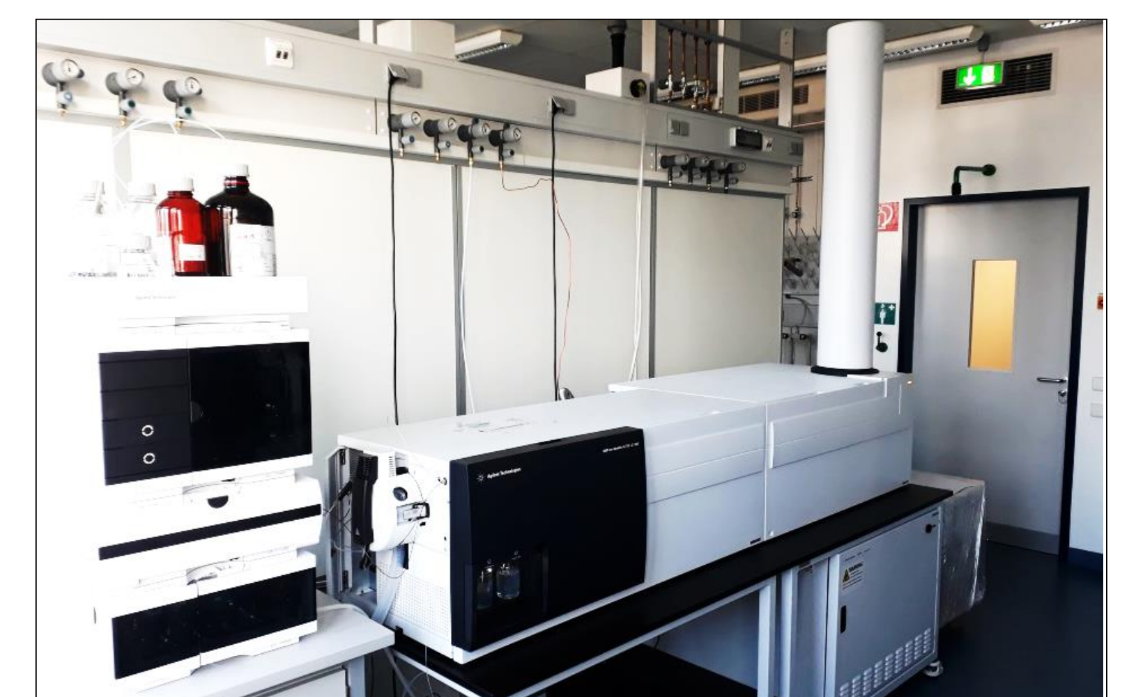
Abb. 2: Das LC-ESI-IM-QTOF-MS Gerät, welches in der Studie verwendet wurde (Agilent Technologies 6560 Ion Mobility Q-TOF LC/MS-System).
