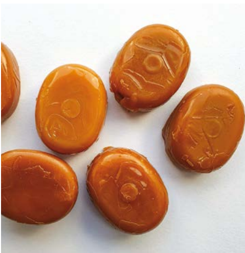
Abbildung 7: Fehleransprache 2391 Außenflächen – Fehlstellen [7].
