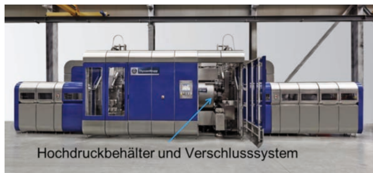
Abbildung 4: HPP-Produktionsanlage mit geöffneter Einhausung
