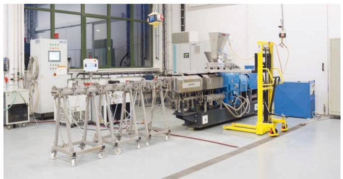
Anlage zur Nassextrusion bestehend aus Extruder und Kühldüse
