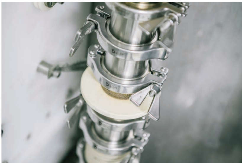
Abbildung 12: Behandlungszelle einer industriellen PEF-Anlage für Flüssigkeiten
