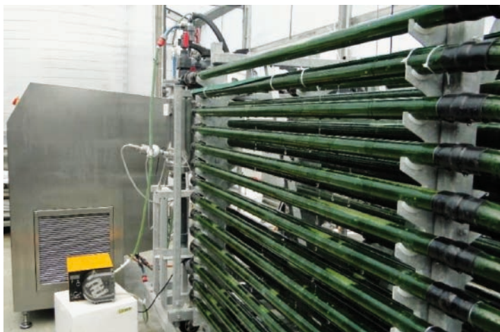
Abbildung 11: Mögliche Implementierung der PEF-Anlage in der Mikroalgenproduktion
