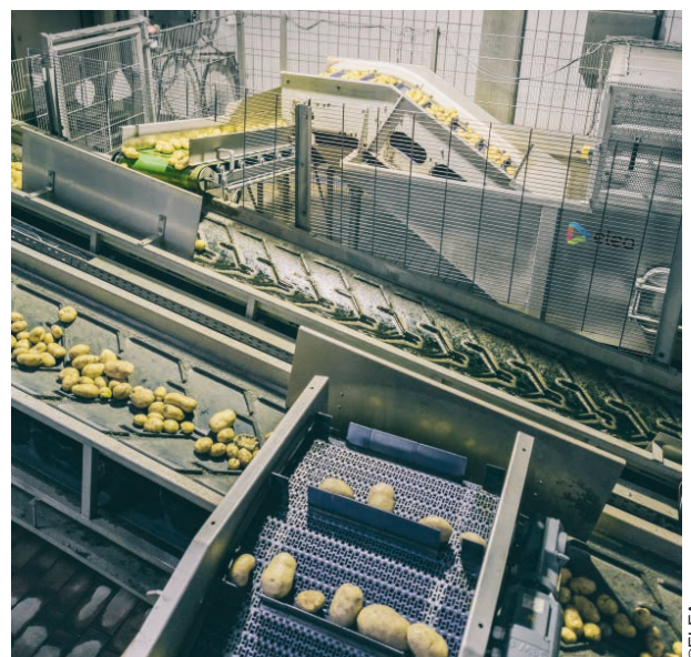
Abbildung 9: Industrielle PEF-Anlage für die Kartoffelverarbeitung
