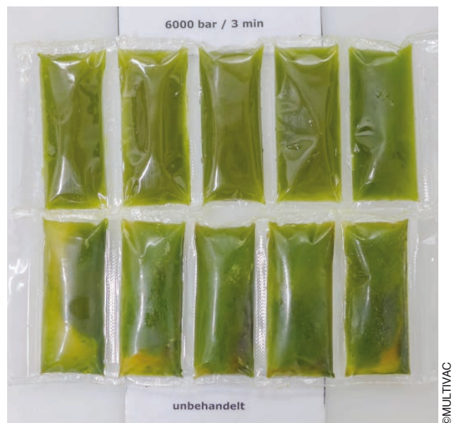
Abbildung 3: Farberhalt bei Weizengrassaft nach der HPP-Behandlung bei 6000 bar (oben) im Vergleich zur unbehandelten Probe (unten)
