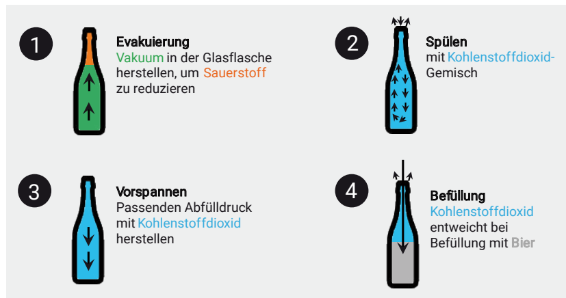
Abb. 6: Vereinfachte Darstellung des Prinzips der Gegendruckbefüllung
